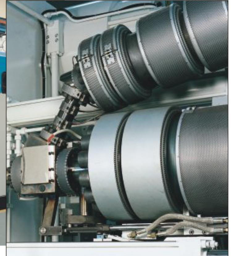
Riscaldatori CRE-IRC utilizzati per impianti ITALTECH.
